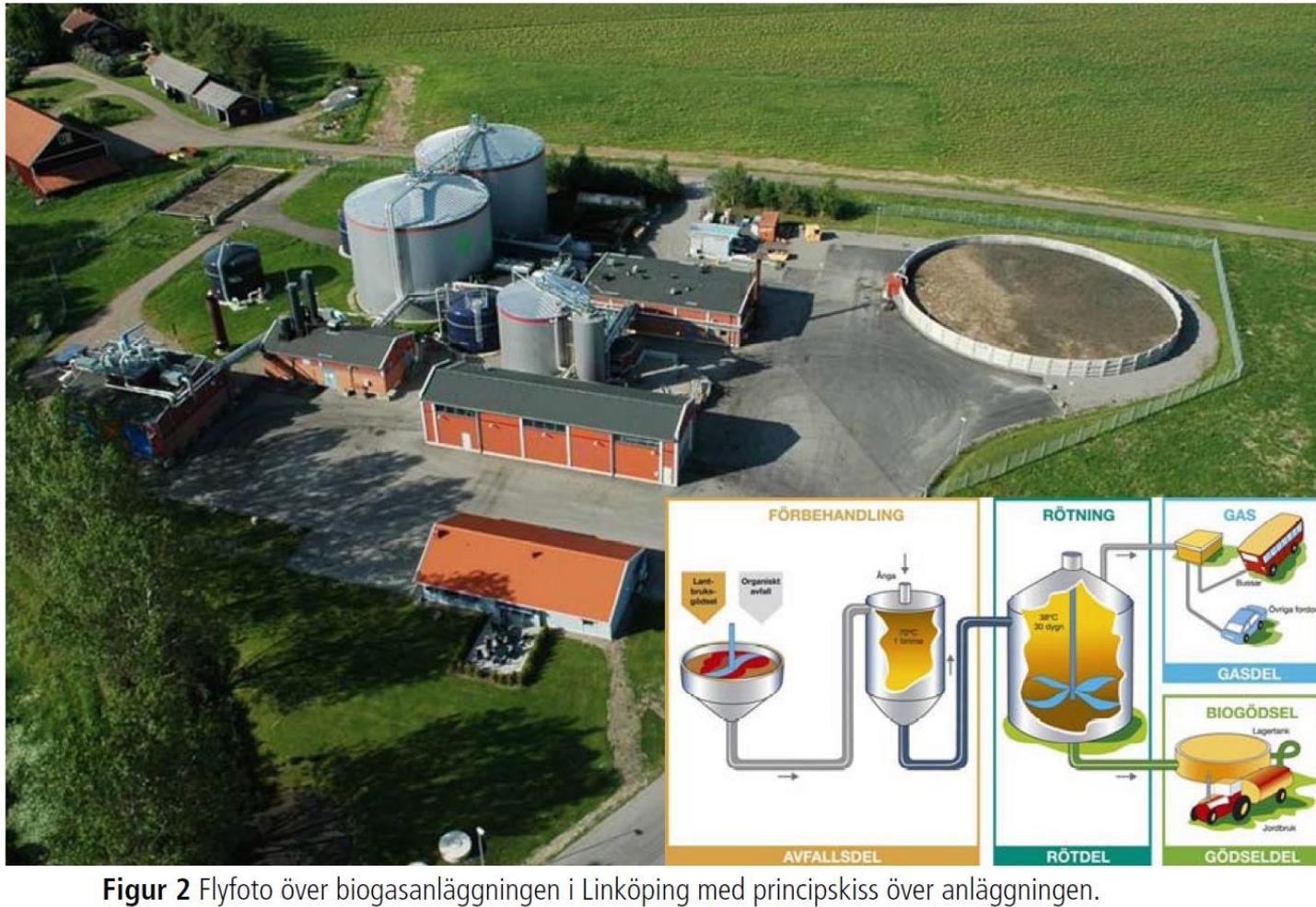
Figur 2 Flyfoto över biogasanläggningen i Linköping med principskiss över anläggningen.
